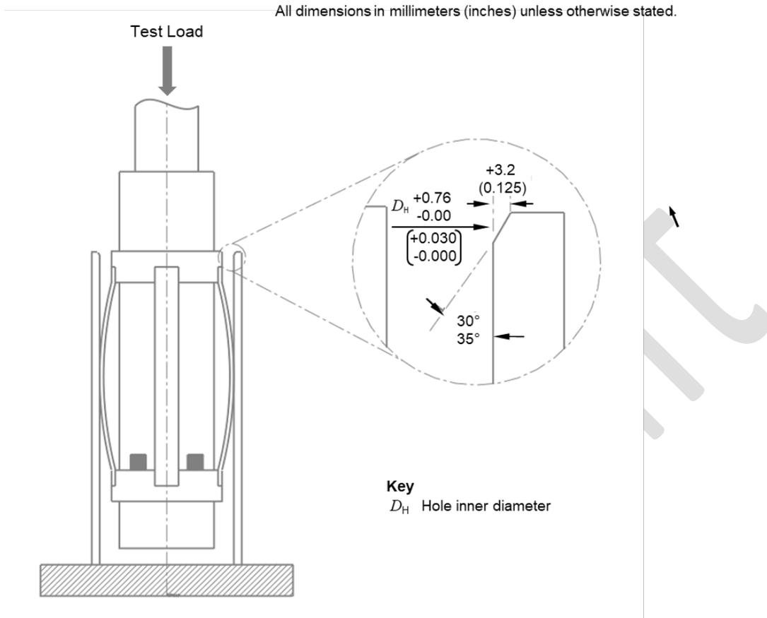
Figure 4—Outer Pipe Inner Edge Bevel
